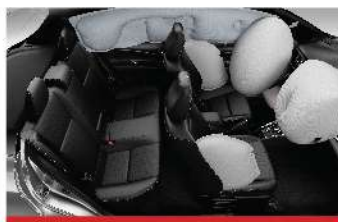
Airbags frontales (conductor y acompañante), de rodilla (conductor), laterales (x2) y de cortina (x2). 2
